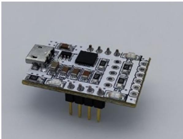
Установите плату USB-UART конвертера в посадочные отверстия обозначенные как USB UART BRIDGE SOCKET. **Снова следите за выводами плат.**
